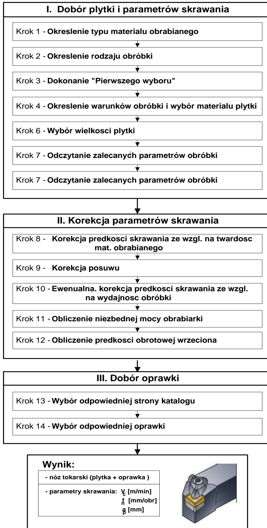
Rys. 11 Algorytm doboru narzędzi i parametrów skrawania
